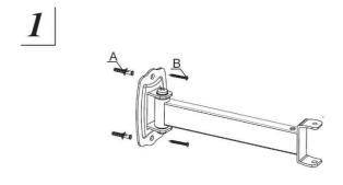
Usando el nivel de burbuja, asegúrese que la placa de pared esta nivelada, taladre dos agujeros con una broca de 10 mm y una profundidad de 50 mm. Inserte los anclajes de pared en los orificios. Luego utilice los pernos largos par dejar fijado a la pared el brazo principal.
