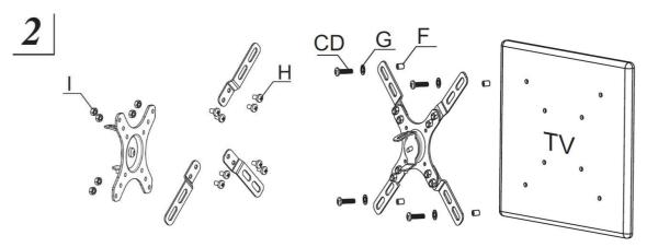
En caso de que su televisor requiera un sistema de fijación VESA superior a 100x100, coloque las aspas accesorias en la base, utilice para ello los tornillos H y las tuercas correspondientes.
