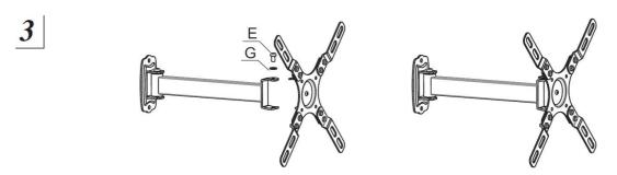
Por último, fije el soporte al brazo articulado mediante los tornillos tipo E. Recuerde siempre utilizar la arandela G para asegurar la fijación. Asegúrese que el resultado del montaje es igual al de la imagen final.
