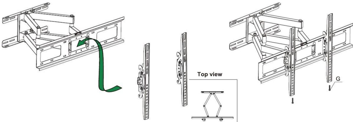
Siguiendo la flecha, introduzca el cableado de su televisor a través de la parte central del soporte, después cuelgue el televisor en la fijación de la pared y asegure que no se mueva con el tornillo tipo G, apriete con cuidado hasta encontrar la posición en que las barras queden fijas y no se desplacen.
