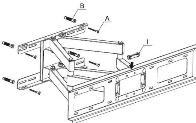
Usando el nivel de burbuja (I), asegúrese que la placa de pared esta nivelada, taladre dos agujeros con una broca de 10 mm y una profundidad de 50 mm. Inserte los anclajes de pared en los orificios. Luego utilice los pernos largos A y los tacos tipo B para dejar fijado a la pared la placa de sujeción principal.
