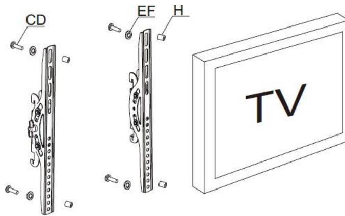
Fije las barras de sujeción a la televisión. Utilice los tornillos C o D (dependiendo de la métrica de su TV) para fijar la tv a su soporte. No olvide colocar entre el soporte y el tornillo la arancela tipo E o F (dependiendo de la métrica) finalmente, en caso de que sea necesario, con el tope de goma tipo H.
